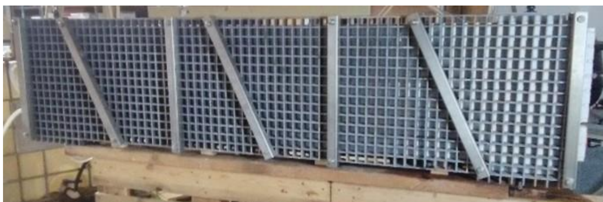
Fig. 3. In- en uitstroomheaders voor de BOX-packets van 20 m 2 , en BOX-module (rechts en onder).
