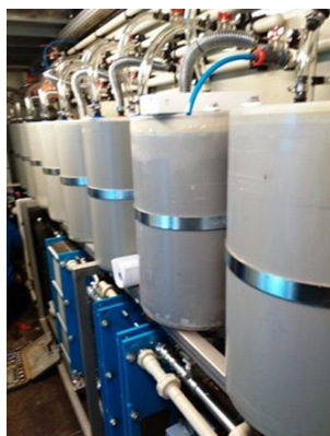
Fig. 1. Spiral wound MD modules van i3.
