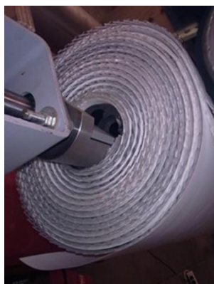
Fig. 1. Spiral wound MD modules van i3.
