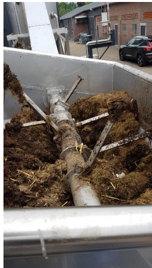
Foto 2 toegevoegde woeler om brugvorming tegen te gaan
