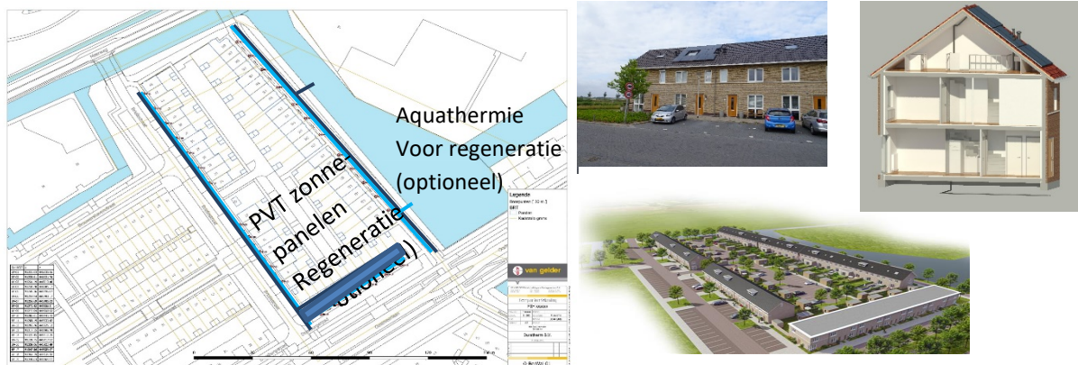
Fig. 6.5 Bodemlussen aangesloten op warmtekoudenet met optionele extra regeneratie met collectief PVT- of aquathermiesysteem
