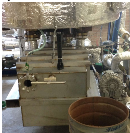
Figuur 1b. Opvangbak voor biochar onder de installatie.
