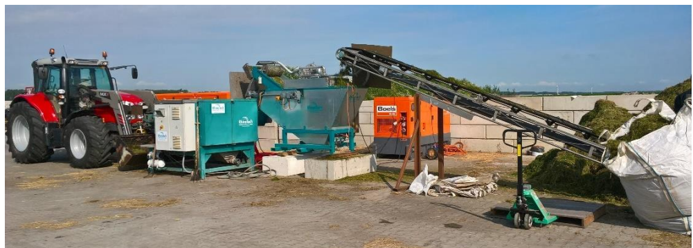
Figuur 1 - Één van de geteste configuraties van de wasstraat op pilot schaal.
