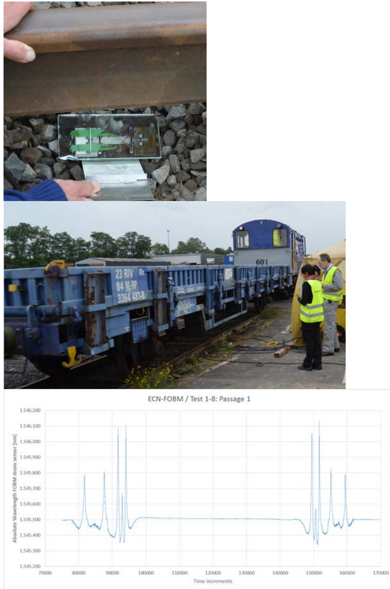
Figuur 6. Toepassing van een LoadWatch sensor bij het onderzoek naar de belasting van treinen op railverbindingen (Voestalpine).
