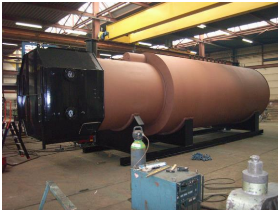
Figuur 24 Afbeelding van een BKC BBK boiler in aanbouw (links) en geïnstalleerd in ketelhuis (rechts)
