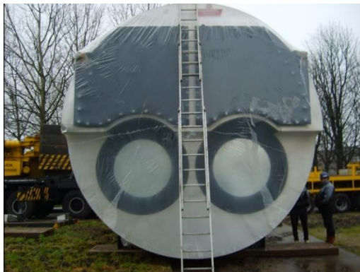
Figuur 23 Afbeelding dubbele vuurgang (links) en opstelling branderinstallatie (rechts) [CONDORBOILER]
