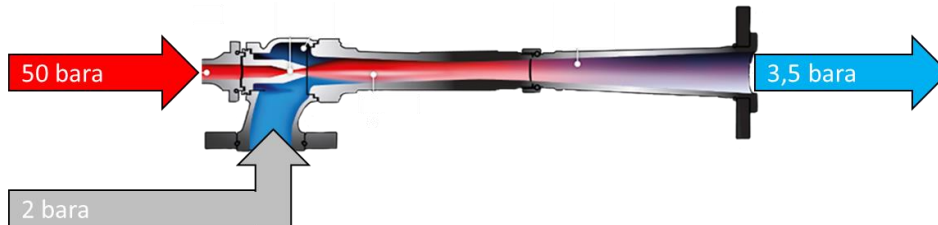
Figuur 3.1 Principetekening thermische damprecompressie; bron: Körting
