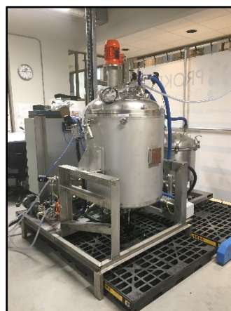
Figuur 1 en 2: Links het verdamper skid en rechts de kristallisator installatie
