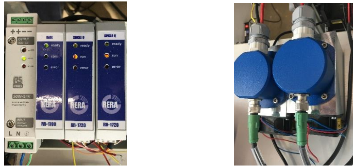
Figuur 1 Foto's van de vermogenselektronica om stroom-spanningscurven van perovskiet modules (links) en de instelbare elektronische belastingen om langdurig modules te kunnen meten tijdens verouderingstesten.
