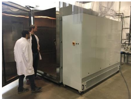
Figuur 2 Foto van de AAA-class LED zonnesimulator voor de klimaatkamer voorzien van een raam. De combinatie van zonsimulator, klimaatkamer en actieve elektronische belastingen maakt het mogelijk om perovskiet cellen en modules gecontroleerd te kunnen verouderen om daarmee te leren hoe verouderingsprocessen werken. Vervolgens wordt onderzocht hoe de processen voorkomen of vertraagd kunnen worden.
