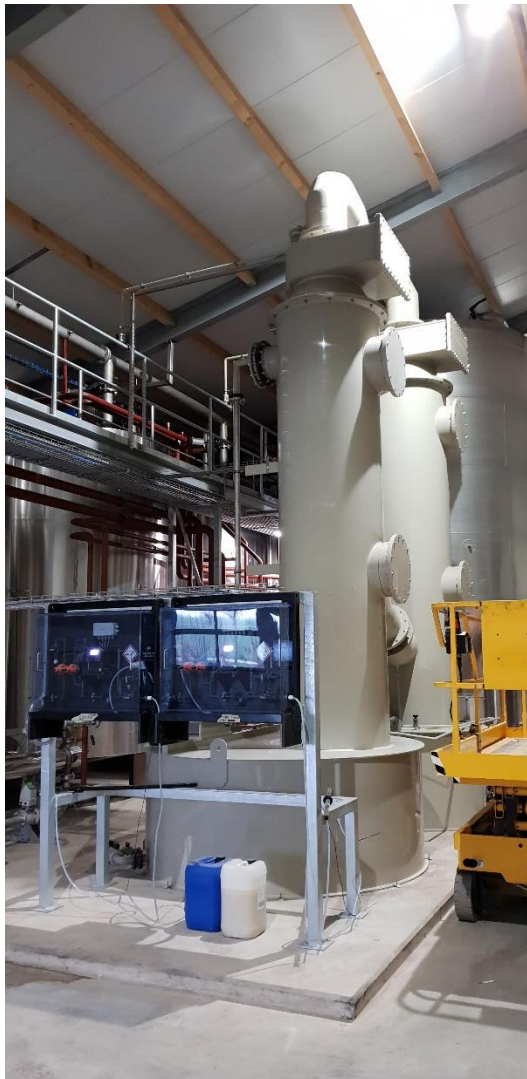
Figuur 3 NAR Installatie met aan de voorzijde de stripper, en aan de achterzijde de wasser
