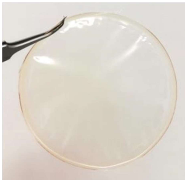
Figure 3 Voorbeeld van een membraan op basis van gesulfoneerd PPE.
