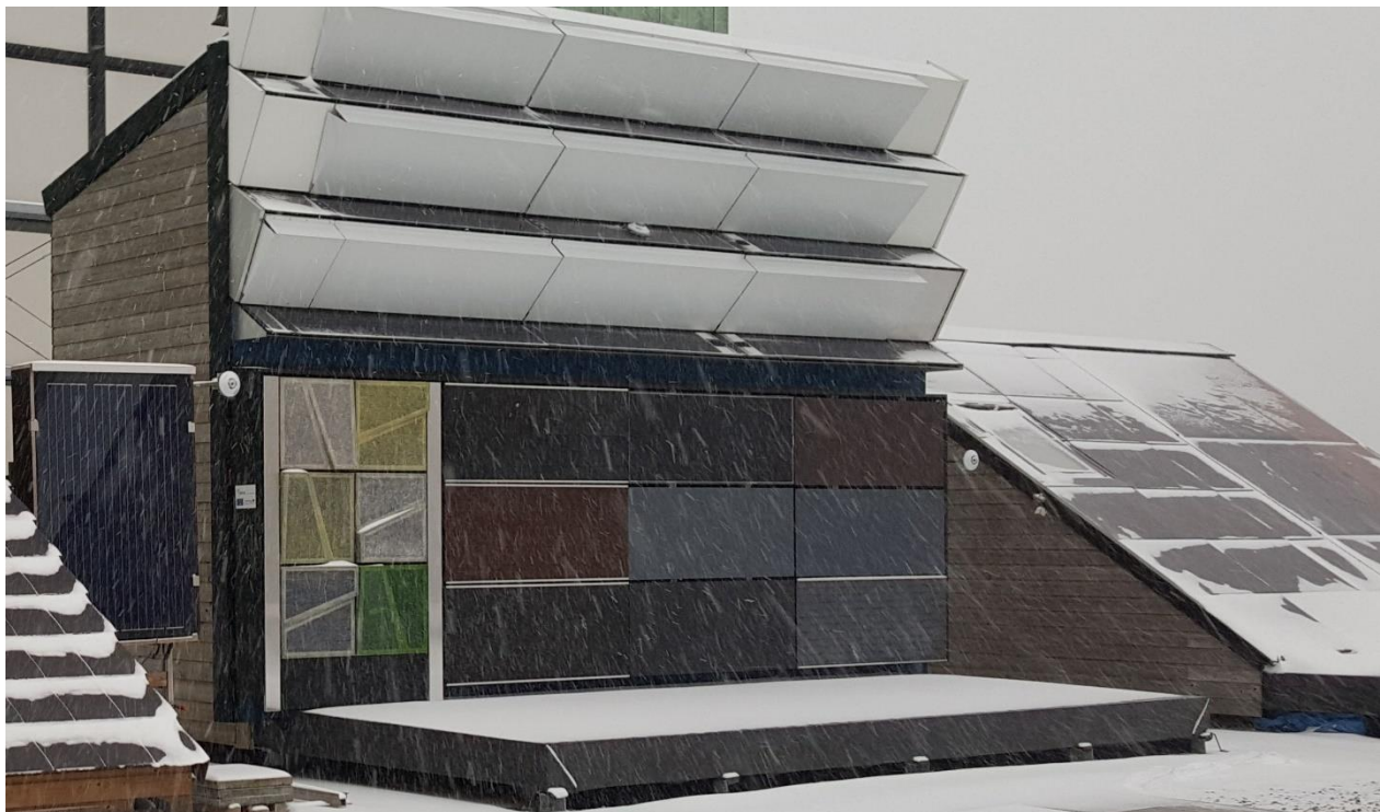
Figuur 7: Bij een vol jaar outdoor veldtest metingen komen alle weer-extremen voor. Rechts is te zien dat de twee prototypes van ReBor en AERspire vol sneeuw komen te liggen zoals alle schuine daken. Het ZigZag-gevelsysteem blijft echter sneeuwvrij, ondanks het feit dat de plateau's met de PV-panelen onder dezelfde hoek zijn gemonteerd als de schuin dak systemen.
