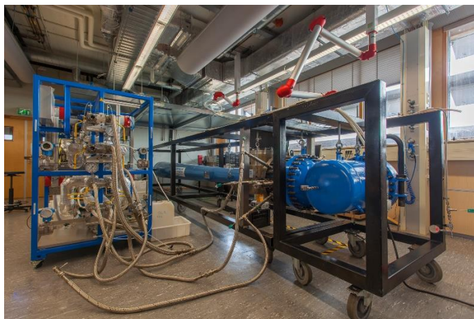
Figuur 3 Thermo-akoestische warmtepomp gebruikt voor glide metingen
