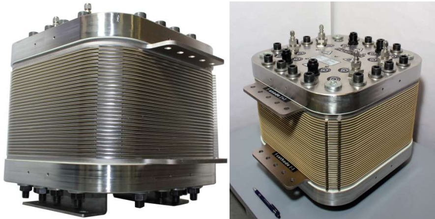
Figuur 2: EL500 30 cells stack, zoals geconstrueerd in NEXTGENP2H2 met een actief oppervlak vanaf ~500 cm 2
