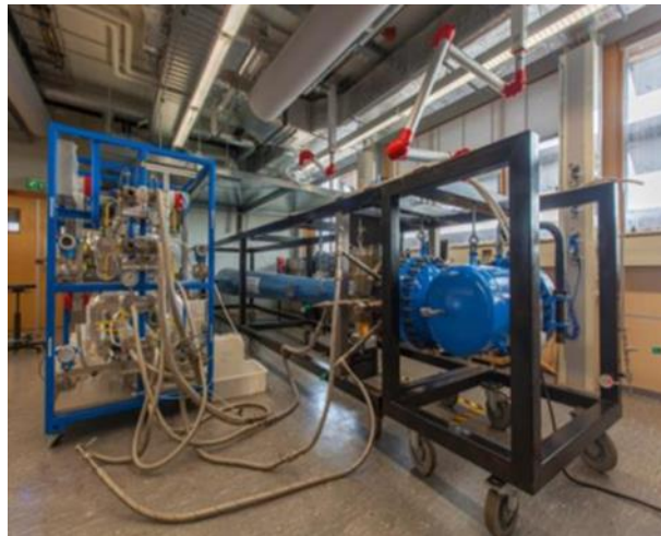
Figuur 8 Foto van een zuigercompressor gedreven TAWP
