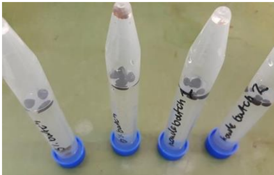
Foto: Calcium -ALE gel bolletjes als check dat het product ook echt alginaat achtige biopolymeren bevat
