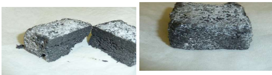
Figuur 9. Grafietschuim met het ingebrachte \text{Na}_2\text{S} .
