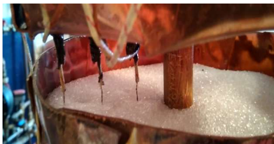
Figuur 31. Geplaatste thermokoppels in het silicagel bed.
