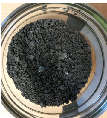
Figuur 12. Voorbeelden van K_2CO_3 gemengd met koolstof.
