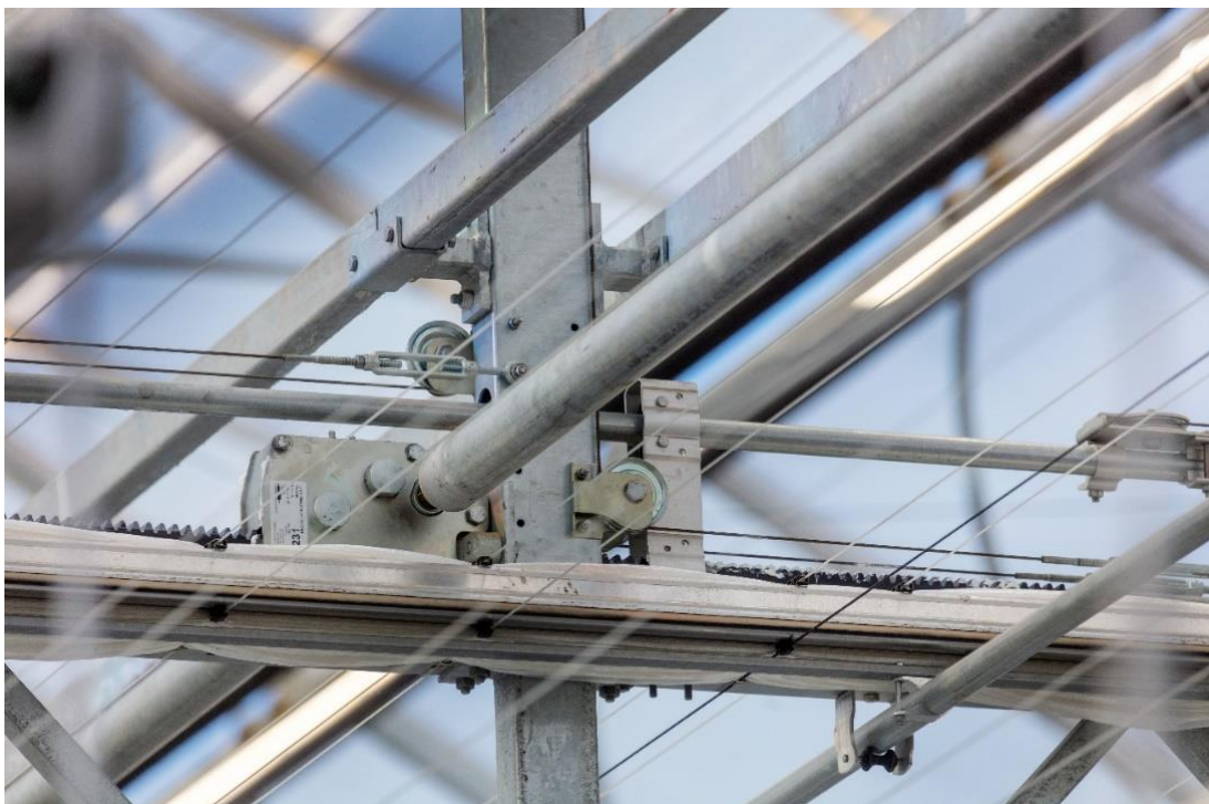
Detail aandrijfas, reductor, tandheugel, trek- duwbuizen, kabels en geleidingskatrollen van het volgmechaniek
