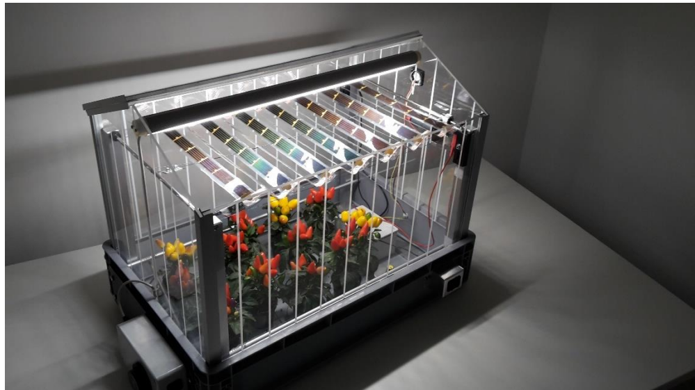
Figuur 7: modelkasje met bewegend (in- en uitschuivend) PV scherm
