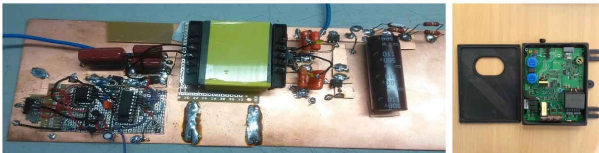
Figuur 12 Prototype PCB lay-out en behuizing van micro-omvormer
