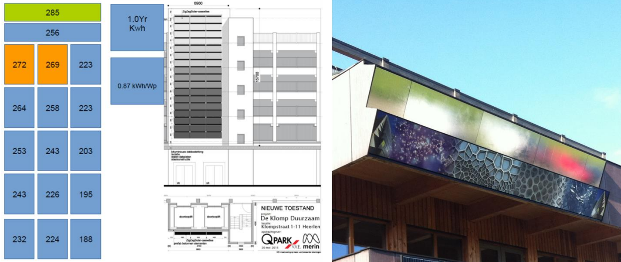
Figuur 8 Links: voorbeeld meetresultaten Q-Park. Er zijn diverse kleurgradaties esthetische beplating aangebracht die invloed hebben op de hoeveelheid gereflecteerd zonlicht. Daarnaast geeft de lichtschaft rechts van de opstelling schaduw op de gevel. De opbrengst wordt per drie ZigZagSolar cassettes gemeten (schematisch weergegeven aan de linkzijde van het figuur). Rechts: foto testopstelling op balkon Wijk van Morgen met onder een print om esthetische vrijheid te demonstreren en boven een reflecterende folie ter maximalisatie van de opbrengst.
