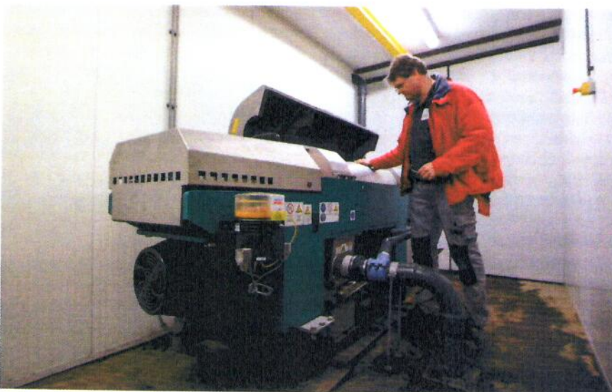
Gertjan Buffinga van Byosis controleert de decanter. Deze centrifuge onttrekt een fosfaatrijke meststof uit het digestaat.
