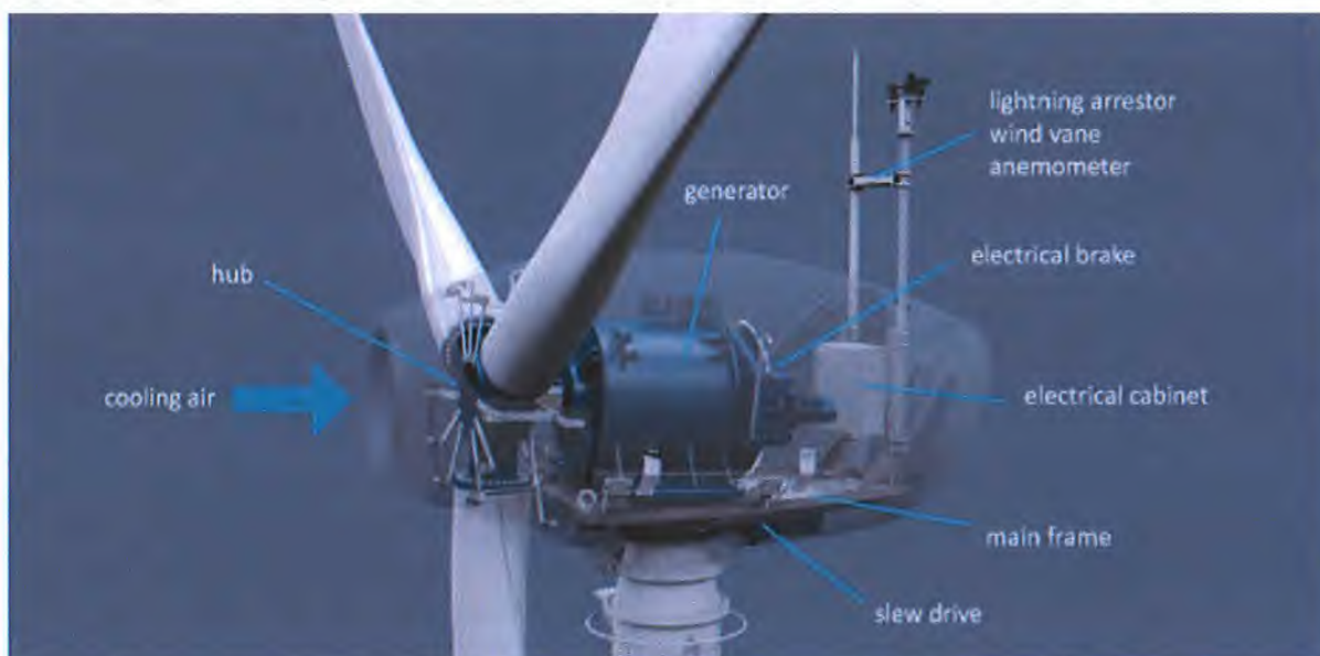
Afbeelding 2 Principe Direct Drive
