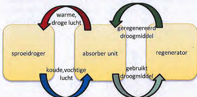
Figuur 1 Schematische weergave van het EELS concept met links de sproeidroger, in het midden de absorber unit die de lucht uit de sproeidroger verwarmd en droogt en rechts de regenerator waar het droogmiddel wordt geregenereerd.
