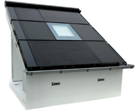
Figuur: Zonnepanelen en dummypanelen verwerkt in kleinschalige testopstelling Bouwbeurs
