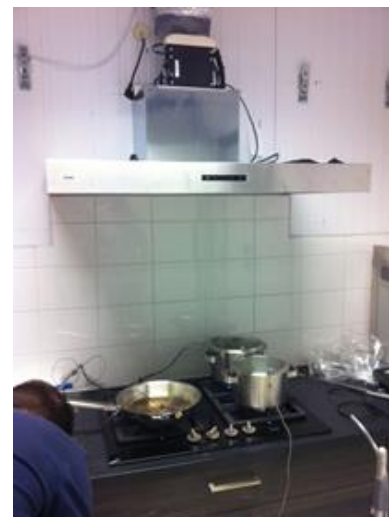
Figuur 2 in het TNO Indoor Air Quality lab experimenteel bepaalde vangst efficiëntie vergeleken met CFD resultaten (bron: TKI KEEK).
