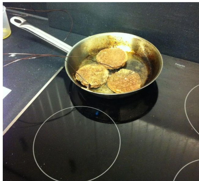
Figuur 28 RVS pan diameter 24 cm met temperatuur sensor midden in de pan en daaromheen drie hamburgers voor bepaling PM 2,5 vangstefficiëntie recirculatiekap.
