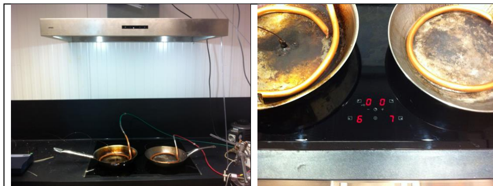
Figuur 20 positie pannen op fornuis, CO 2 injectie buis en instelling kookplaat.
