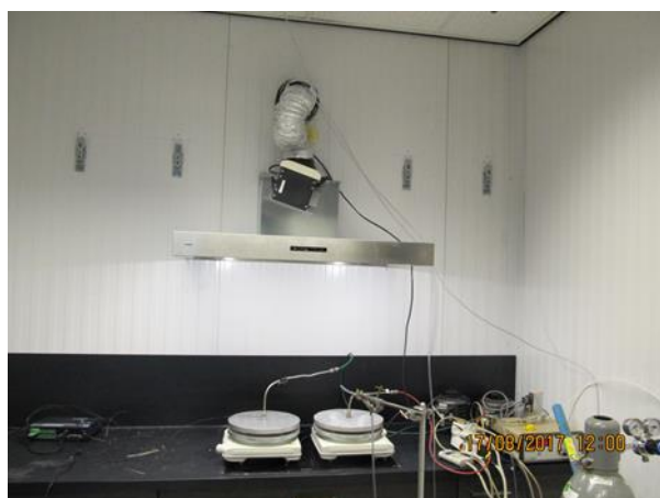
Figuur 17 .ASTM emitters op twee 600 W elektrische verwarmingsplaatjes in MEC lab.
