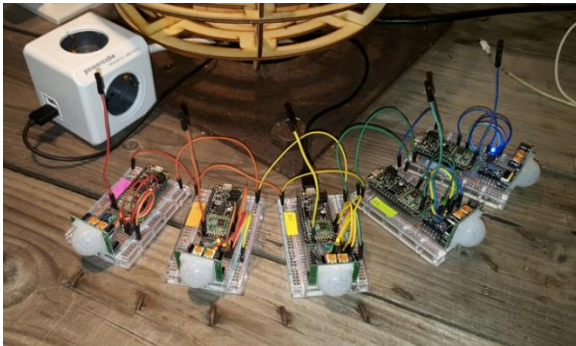
Afbeelding 2. Eerste vijf 433MHz mini-sensor-modules voor test en demo.
