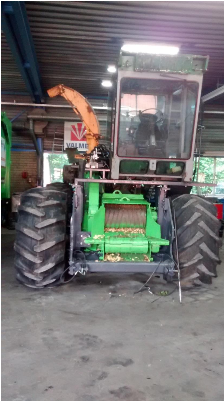
Figuur 11: Carrosserie met de chipper die aan de voorzijde zichtbaar is.
