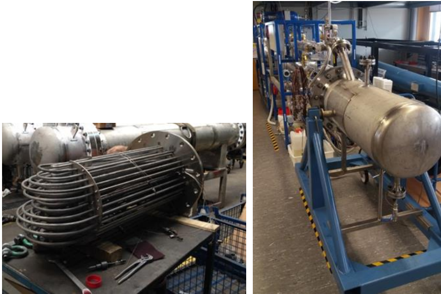
Figuur 1 Laboratorium testopstelling voor PCM warmteopslag (a) assemblage bij Bronswerk Heat Transfer, (b) PCM testopstelling in het lab bij ECN.
