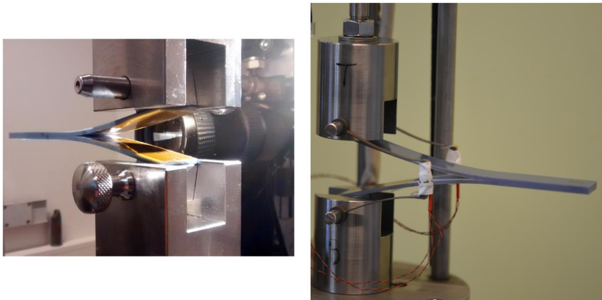
Figuur 12: links, Gestandaardiseerde DCB test bij kamer temperatuur in the PT lab. Rechts, Speciaal vervaardigde cryogene DCB opstelling, ontworpen voor het uitvoeren van dezelfde test bij 77 K.
