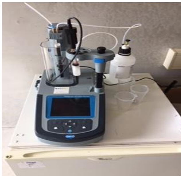
Foto 5: Fos/Tac apparatuur (klein lab op locatie)
