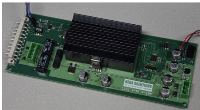
Figuur 2: Foto van een elektrische load. Deze zijn binnen het TRUST project ontwikkeld: 44 stuks zijn geïmplementeerd in de hybride degradatie-opstellingen
