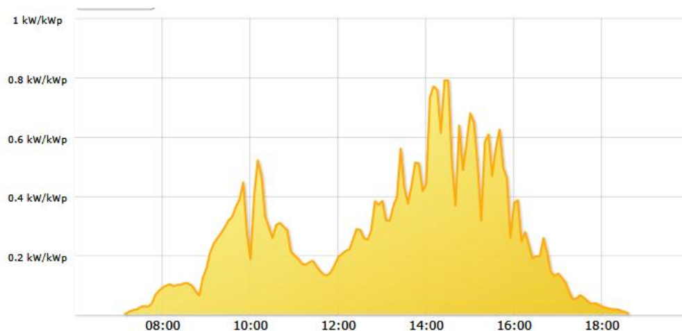
Afbeelding 3.16 Genormeerde output PV systeem in Deventer (Solarlog data, postcode 7413 VT, 17 maart 2017)
