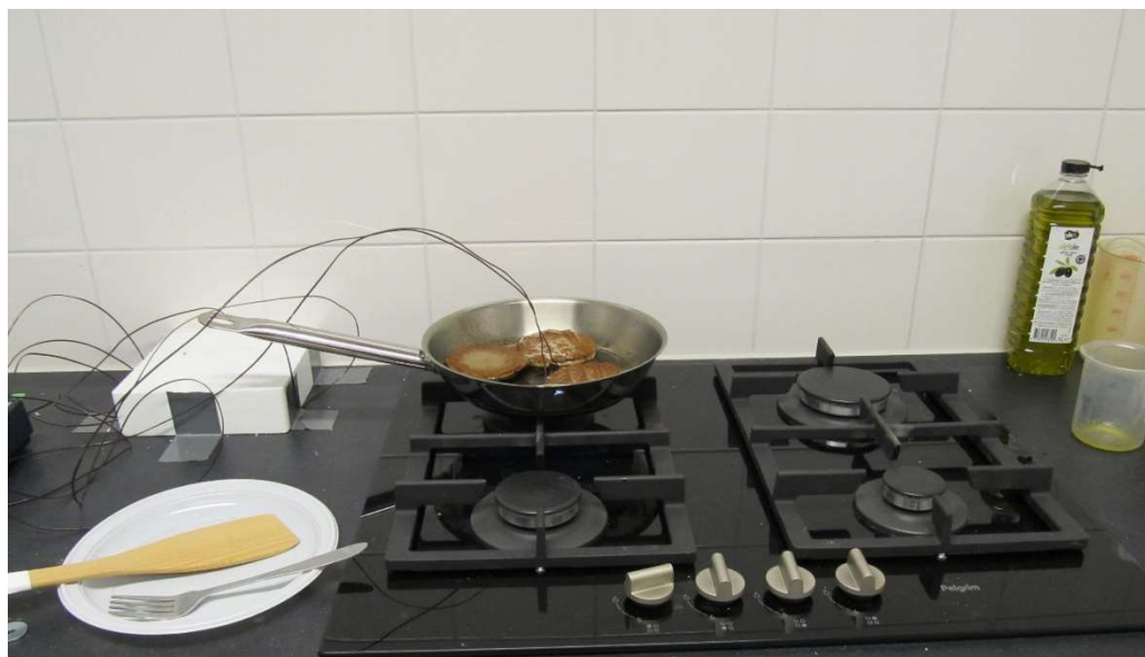
Figuur 2 kookopstelling voor het bakken van de hamburgers, er is geen afzuigkap aanwezig.
