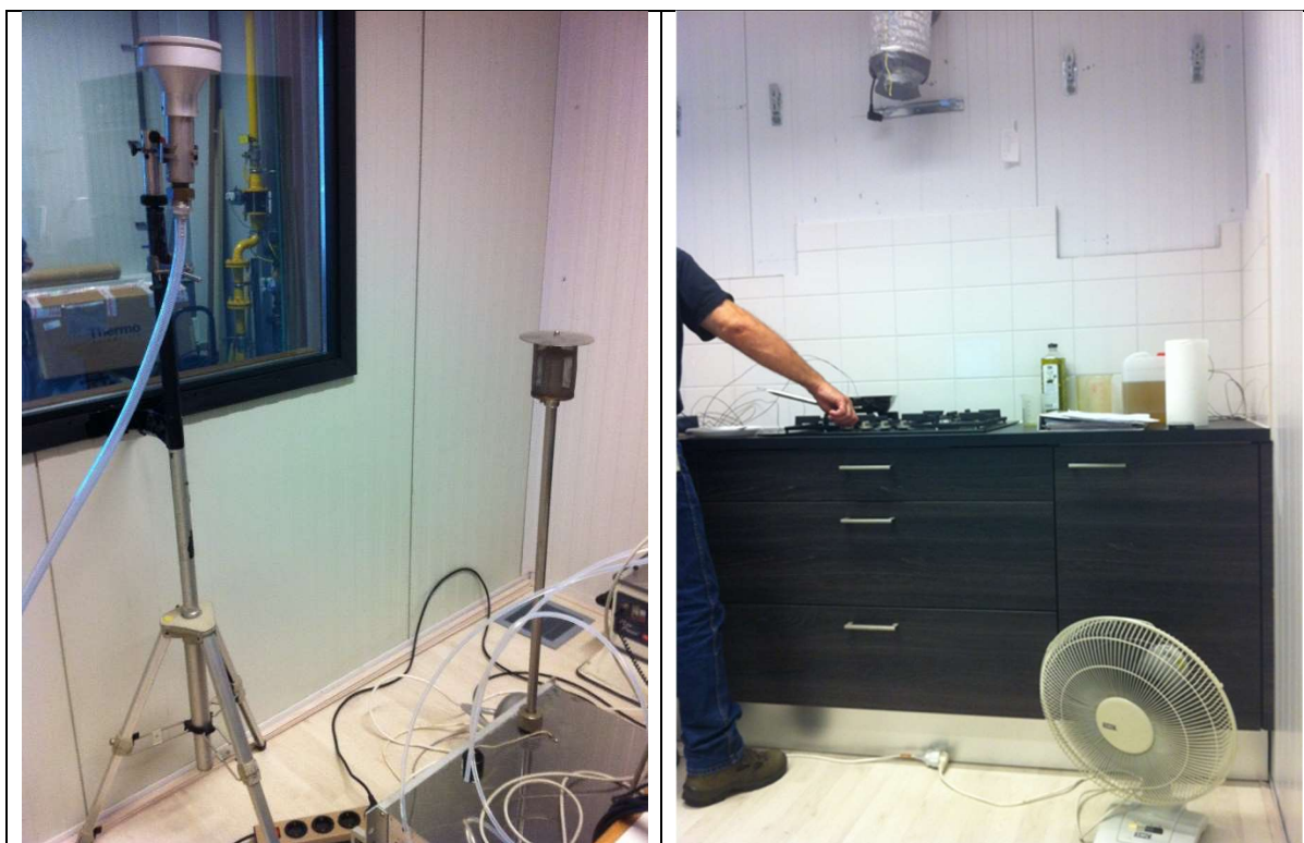
Figuur 3 linker foto: links filterhouder voor PAK monstername, rechts aanzuigkop van MAAP. Rechter foto: mengventilator.
