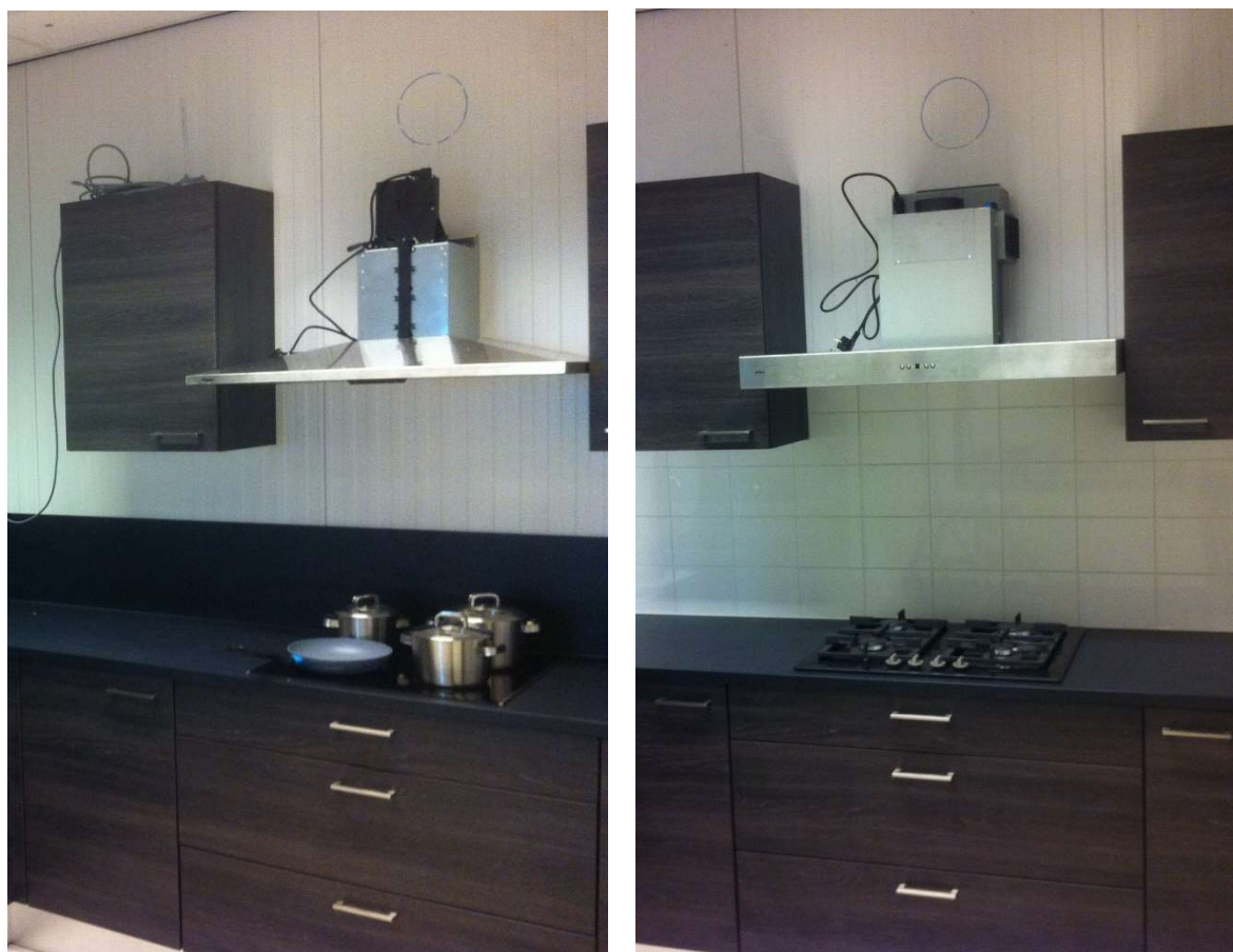
Figuur 1 keukelopstelling ten behoeve van inductief koken (links) en koken op gas (rechts) in klimaat kamer.
