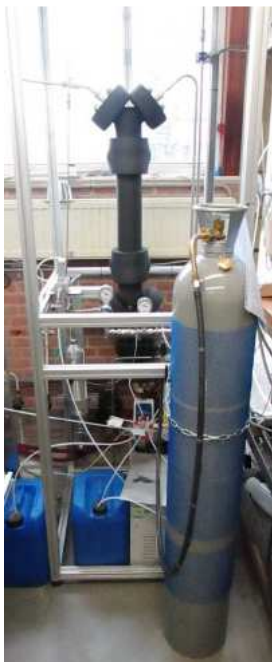
Figuur 1: Opstelling ECN om gasflessen voor ECN te bemonsteren
