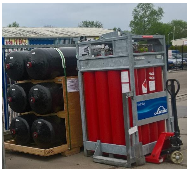
Figuur 20: foto een voorbeeld waterstof 'bundel' of 'pakket' (rode cilinders) en commerciële composiet waterstof cilinder van Hexagon-Raufoss met inhoud 450 liter.
