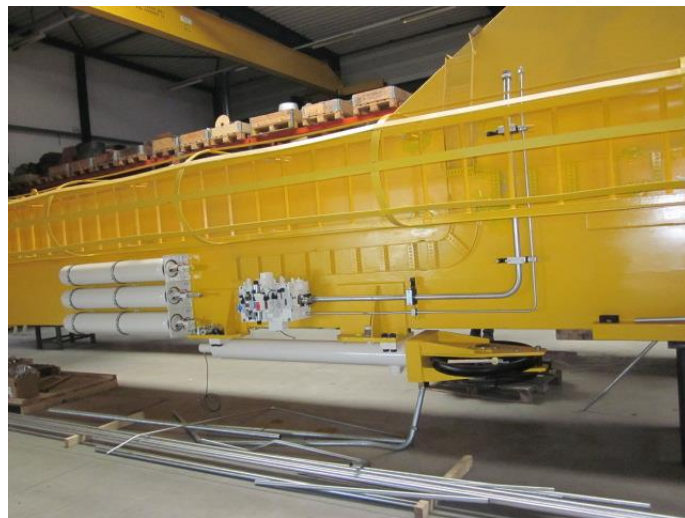
Heave compensation systeem op de kolom
