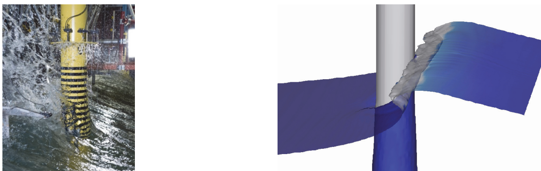
Figuur 1: Golf impact op een monopile wind turbine fundatie, gemodelleerd in de tank en in CFD (Computation fluid dynamics)
