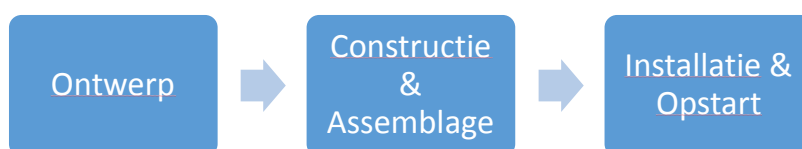
Figuur 4: Project is verdeeld in drie fasen: Ontwerp, Constructie en Installatie. Iedere fase is onderverdeeld in werkpakketten (WPs).
