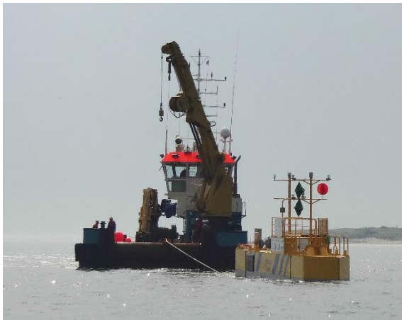
Figuur 15 Het aankoppelen van de BlueTEC Texel aan de ankerlijnen
