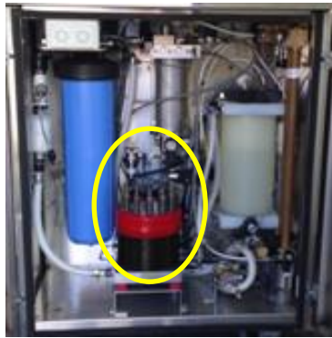
Figuur 17: PEM stack in elektrolyser
