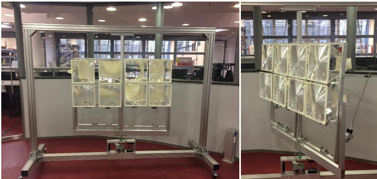
Figuur 7. HCPV-GO multi-systeem voor gebouwde omgeving met hierin 8 van de 12 concentrators en in verrijdbaar subframe.
