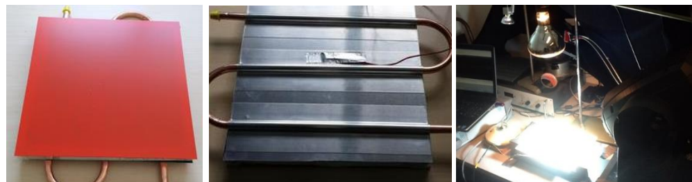
Figuur 4: collector met rode coating die absorbeert in het NIR (links). Lab opstelling waarmee de performance van de coating is bepaald, met twee lampen (rechts) en thermokoppel aan de achterkant (midden).
