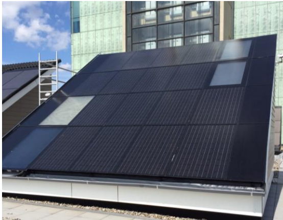
Figuur 5. Prototype AER dak op de SolarBEAT, links onder zijn 2 commerciële zonthermische collectoren, rechtsboven de Suntrap collectoren geïntegreerd.
