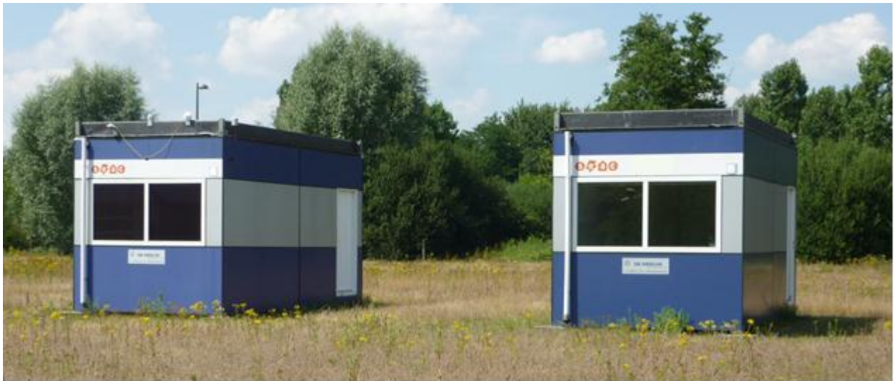
Figuur 1 Veldtest met Smart Energy Windows in de linker cabine en referentieglass (en niet zichtbare jaloezieën) in de rechter cabine.
