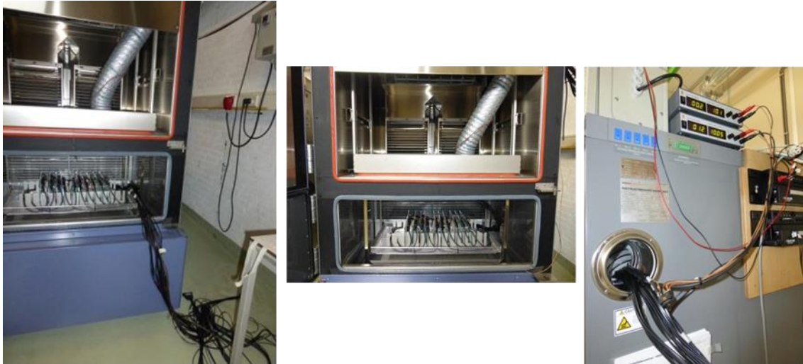
Figuur 11 Overzicht van de fretting corrosion testopstelling
