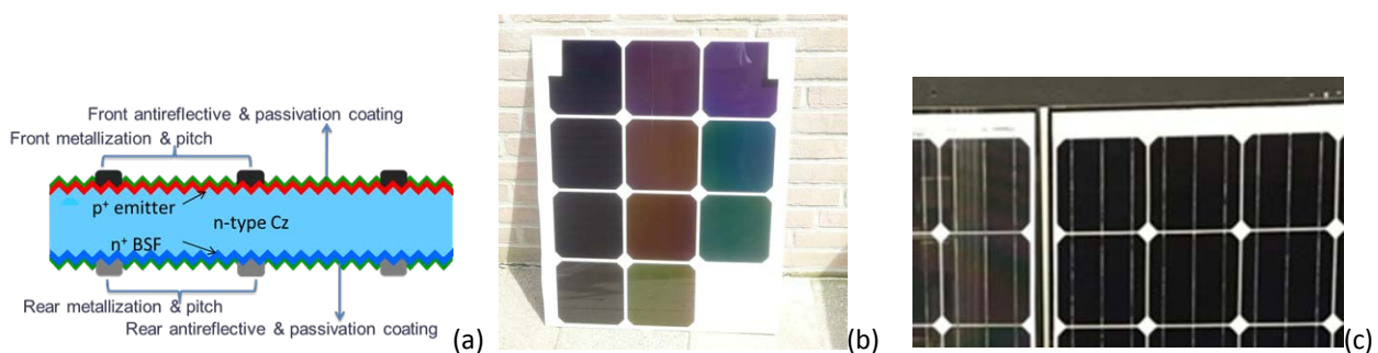
Figuur 1a: doorsnede van een n-Pasha cel; figuur 1b: laminering van verschillende gekleurde n-Pasha cellen; figuur 1c: interconnectie van n-Pasha cellen in een module
