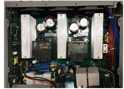
Figuur 4 DC-AC omvormer
